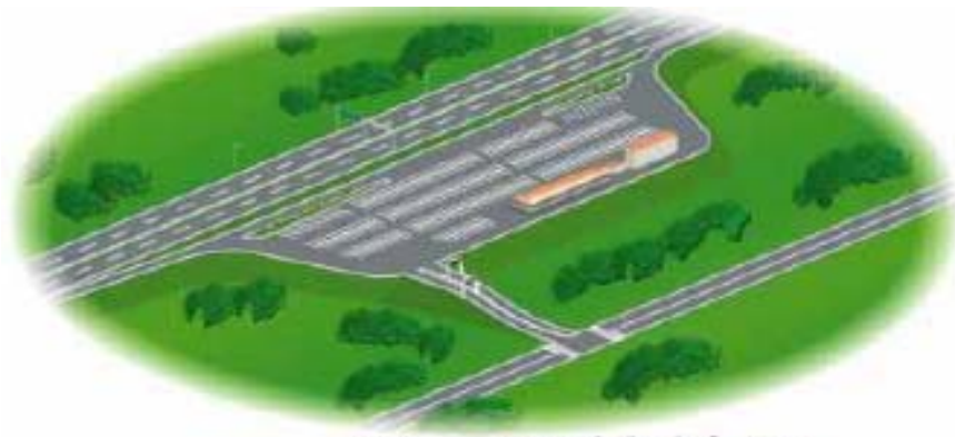
〔SA・PA接続型〕 既存のSA・PAを活用して 一般道路と接続するものです。
